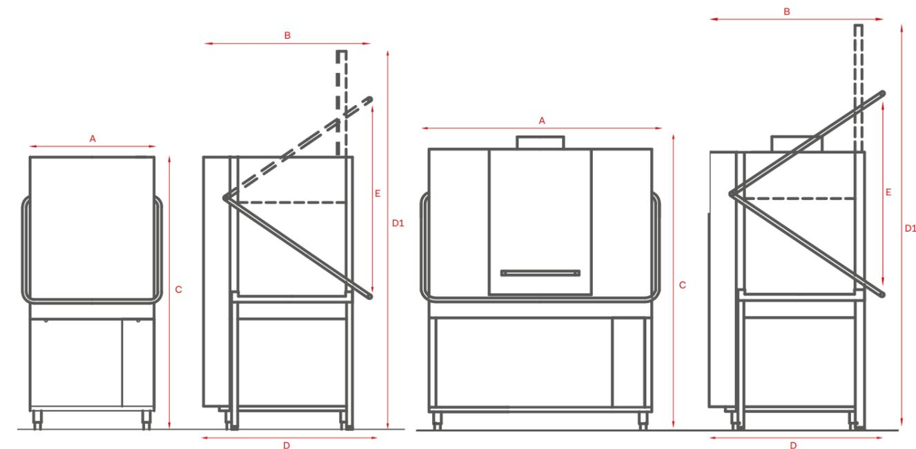
Die Höhe der Maschine (C) mit CRC (wärmerückgewinnungssystem) ist + 300 mm.
