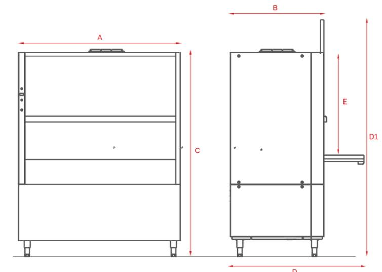
Die Höhe der Maschine (C) mit CRC (wärmerückgewinnungssystem) ist + 300 mm.
